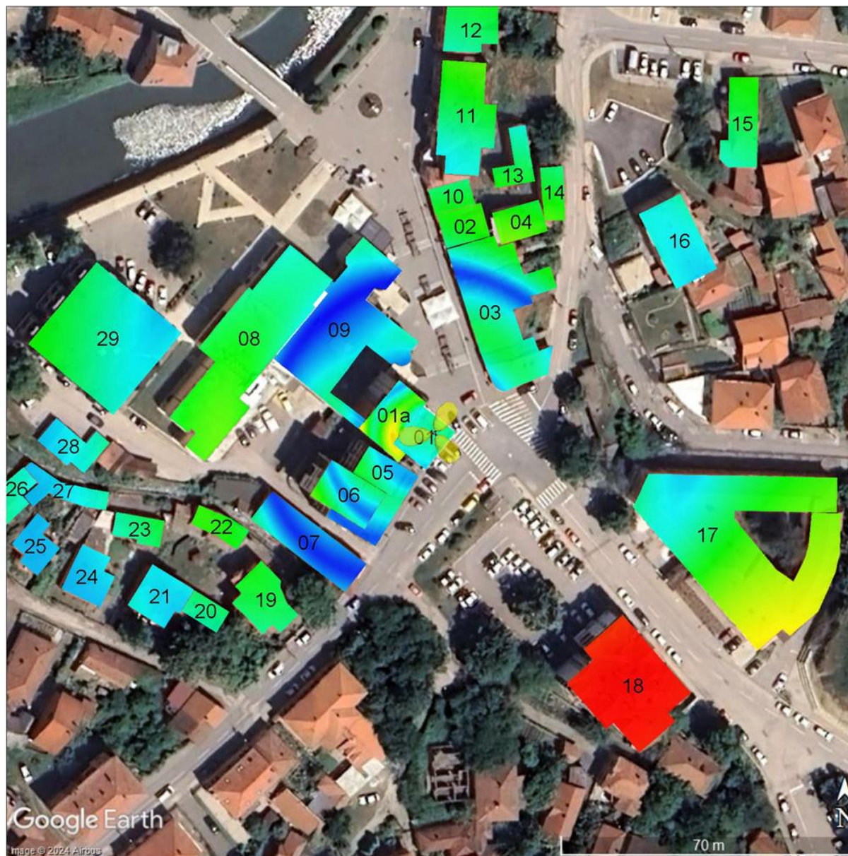
Слика 5.10. Јачина електричног поља унутар објекта када радио-систем LTE800 оператора Telekom Srbija ради максималним капацитетом
